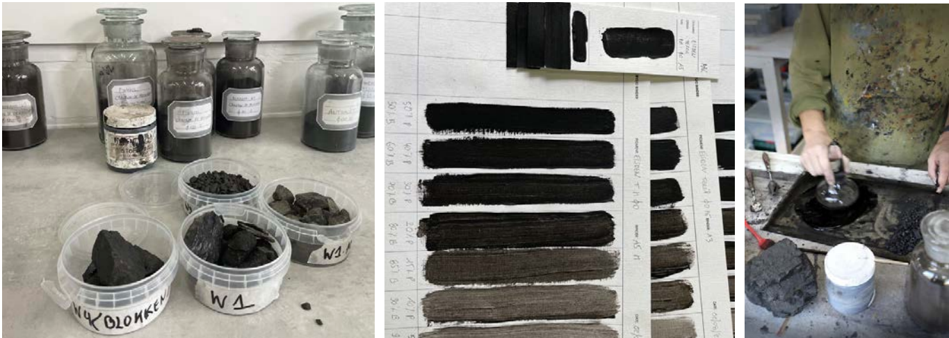
Afbeelding 2 Links: Gebroken en gemalen steenkool uit de zeven voormalige mijnzetels van het Kempisch bekken. Midden: Proefstroken waarop de gebruikte steenkool en de binder staan genoteerd. Rechts: Het bereiden van de pigmentpasta (foto: Alain Terwingen).
